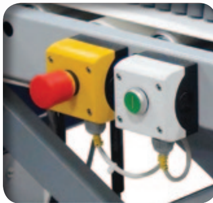
Start cycle button and stop emergency button on infeed conveyors Extra startknopf und not-aus schlag taste auf der fördereinheit im einlaufbereich
